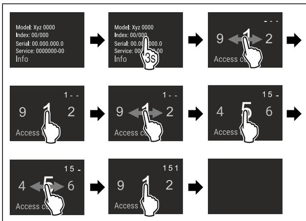
Fig. 5 Примерное изображение, доступ при помощи числового кода **151**
