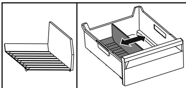
Fig. 114 Примерное изображение разделителя отделения для льда
