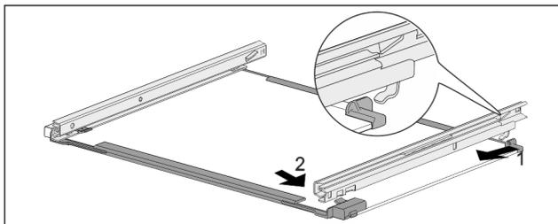
Fig. 103 Стеклянная пластина с направляющими
