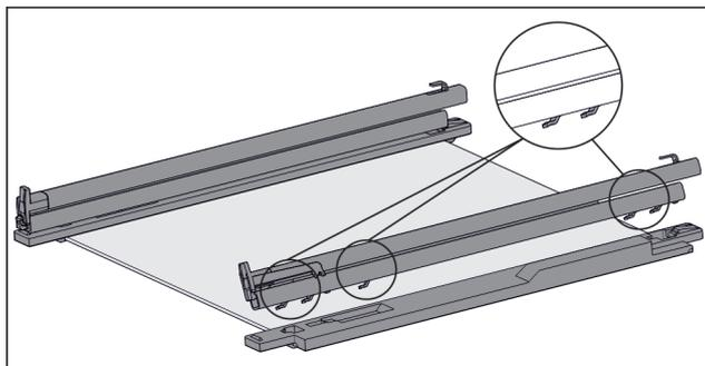
Fig. 111 Стекла́нная пластина с направляющими и крепежными элементами
