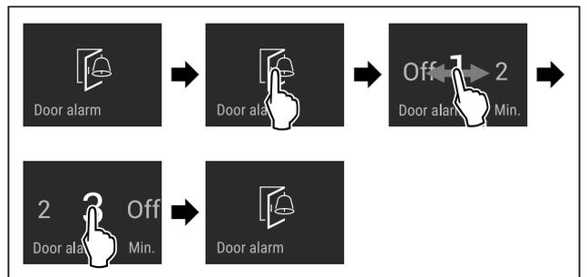
Fig. 52 Примерное изображение: переключение значения для сигнала открытой двери с 1 минуты на 3 минуты.
