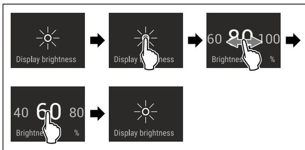
Fig. 50 Примерное изображение: переключение с 80 % на 60 %.
